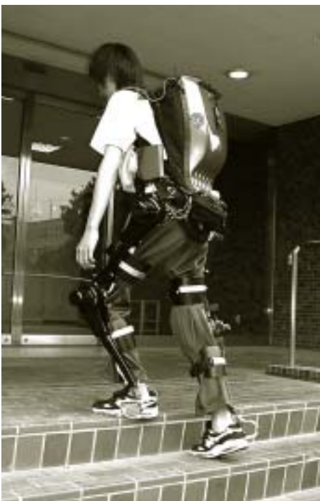
システム情報工科学研究科の山海嘉之教授による歩行補助具としての脚力増強システムHAL (hybrid assisted leg) 山海教授と研究室の大学院生は、この技術を求めている人々への適用を促進するため、本年6月にベンチャー企業として株式会社CYBER DYNEをスタートさせました。
